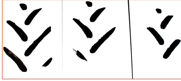
Kuva 3.4: Rengaspaineen vaikutus renkaan kosketusalaan, vasemmalla 0,5 bar, keskellä 1,0 bar ja oikealla 1,5 bar rengaspaine
